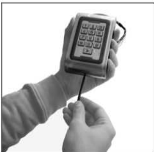
3 • Con la llave hexagonal (C), afloje los tornillos en la totalidad y retire la tapa trasera.
